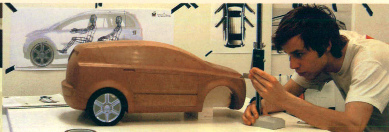
7. 最后检查——在完成的油泥模型上检查尺寸
