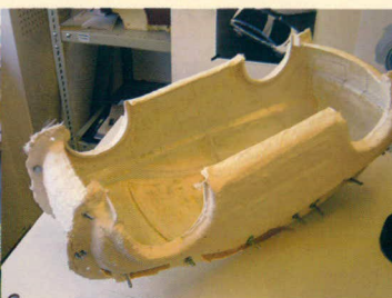
9. 将5片阴模组成一体，形成完整阴模
