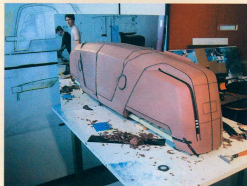
对称的，半边油泥模型和仿真货运火车模型，比例1:10
