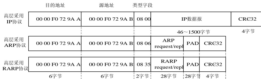
图 1.8 采用 TCP/IP 协议族的 MAC 帧结构示意图
