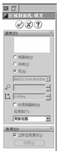
图 1-35 取消剖面线的显示
