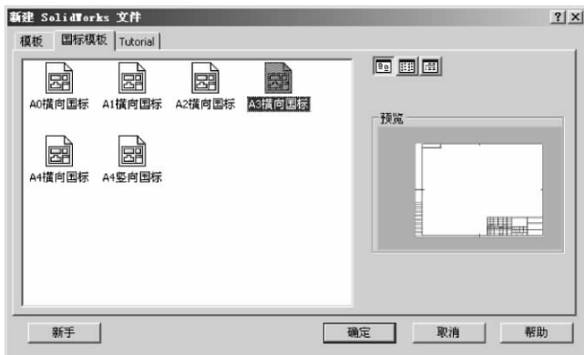
图 1-18 选择工程图模板
