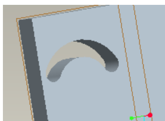
图 2-18 切割圆弧槽后的底板
