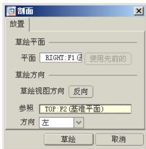
图 2-1 更新设置后的“剖面”对话框
