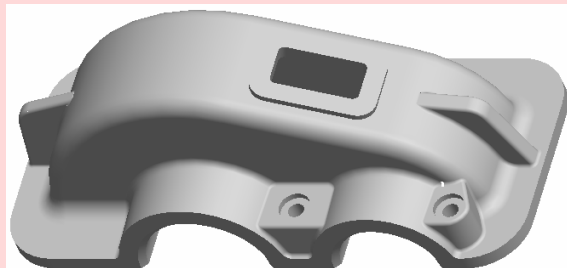
图 4.3.1 减速器上盖三维效果图
