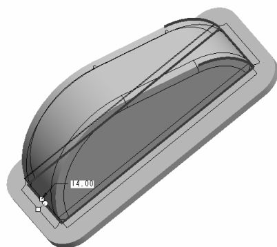
图 4.3.28 选取要创建倒圆的边
