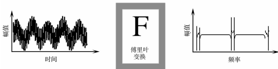
图 1.1 复杂正弦波叠加信号的傅里叶变换
