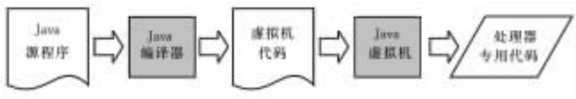
图 1-1 Java 编译程序的工作原理
