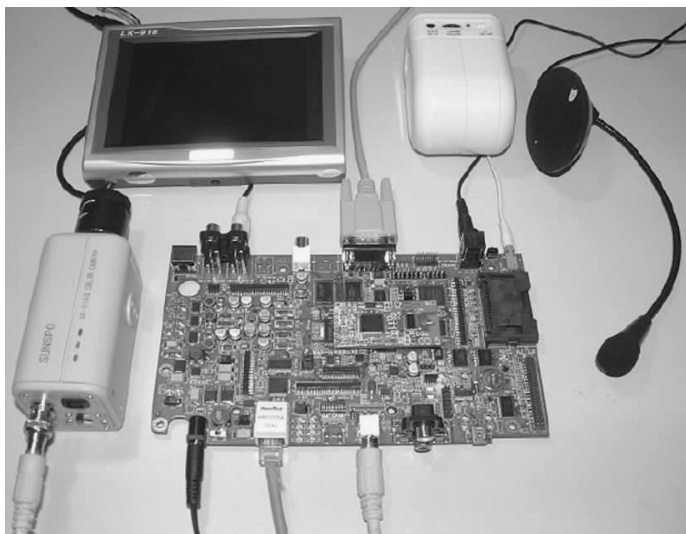
图 2-2 闻亭 DaVinci 开发板硬件连接图
