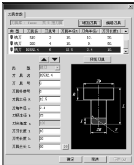
图 0-22 填写铣刀参数
