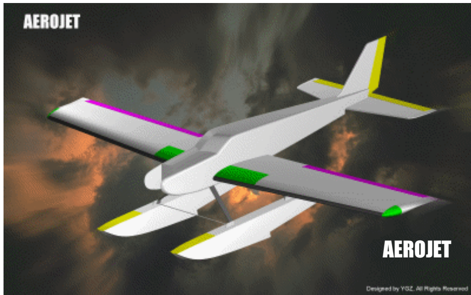
彩图 16 这是在水上飞机的三维线框的基础上添加表面后使用 AutoCAD 渲染的图像。
