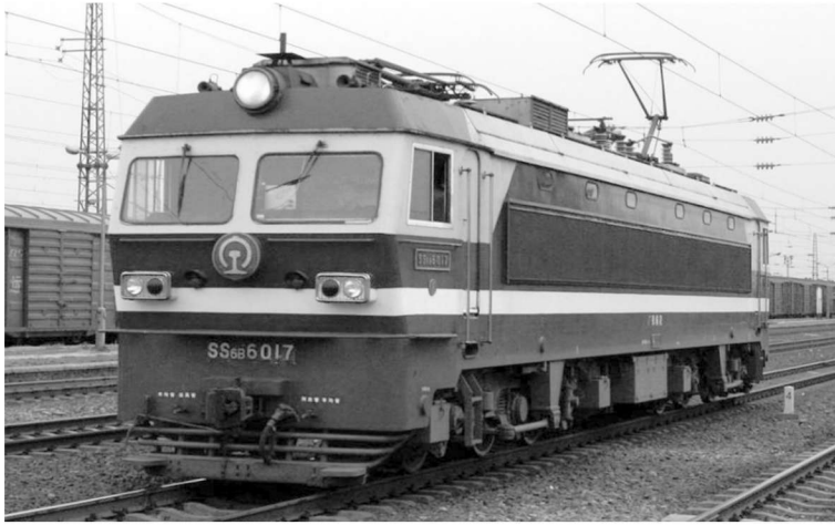
图 1-1 我国采用电力机车牵引的铁路列车车头
