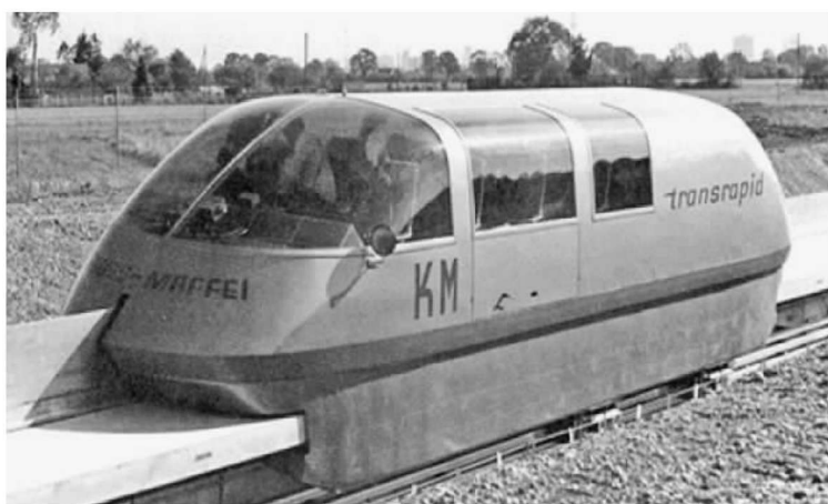
图 1-1 德国 TR02 型磁浮试验车(1971 年)
