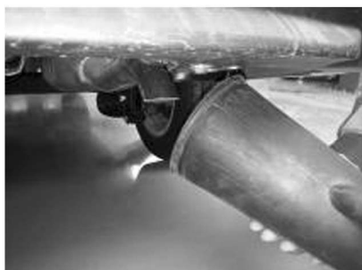
图 1-3 安装尾气排放装置
