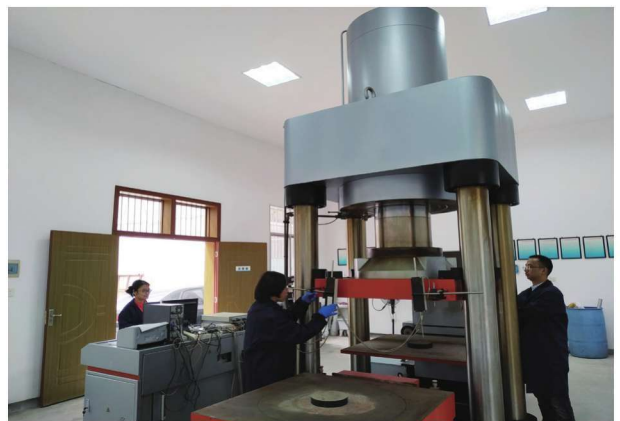
100吨冲剪机试样检测
