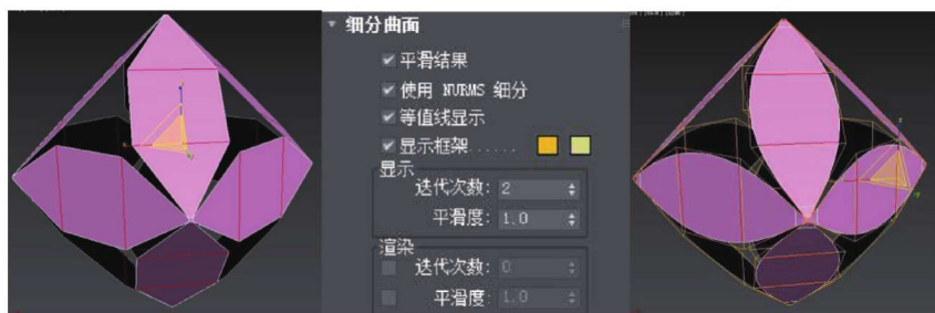
图 1-1-17 对连接线进行均匀缩放
