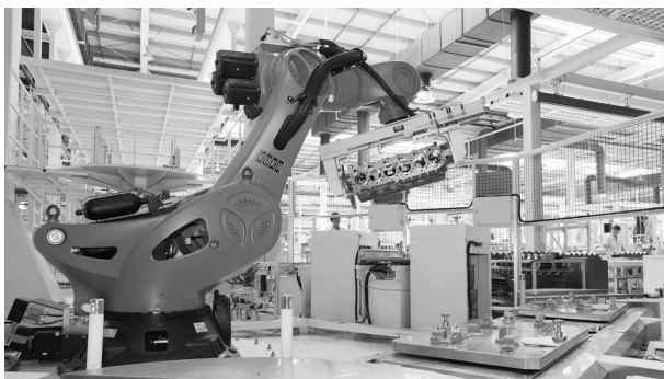
图 1-1 KUKA KR 1000 titan 重载机器人(负载 1000 kg)
