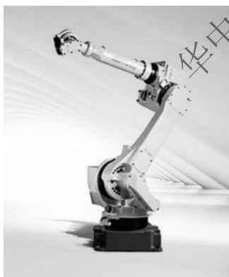
图 1-3 FANUC M-710iC/50H 机器人 (负载 50 kg)
