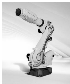
图 1-2 FANUC R-2000iB/170CF 机器人 (负载 170 kg)
