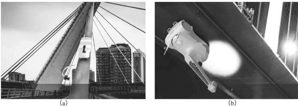
图 1-1-11 爬索、爬壁机器人桥梁检测应用
