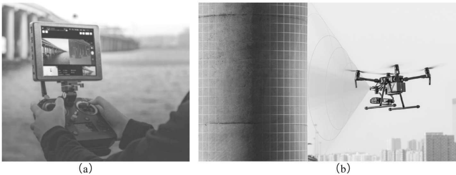
图 1-1-10 无人机桥梁检测应用
