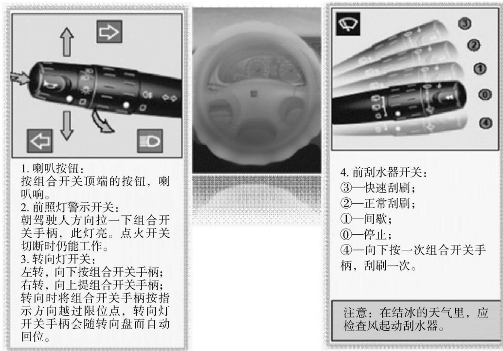
图 1-1-5 汽车常用的组合开关及其说明
