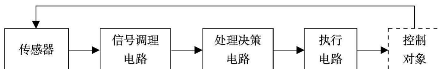
图1-4 闭环控制下电子系统组成电路示意图
