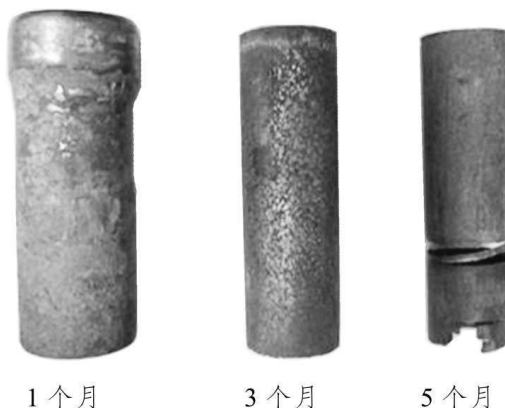
图1 不同服役时间的接箍样品的实物照片
