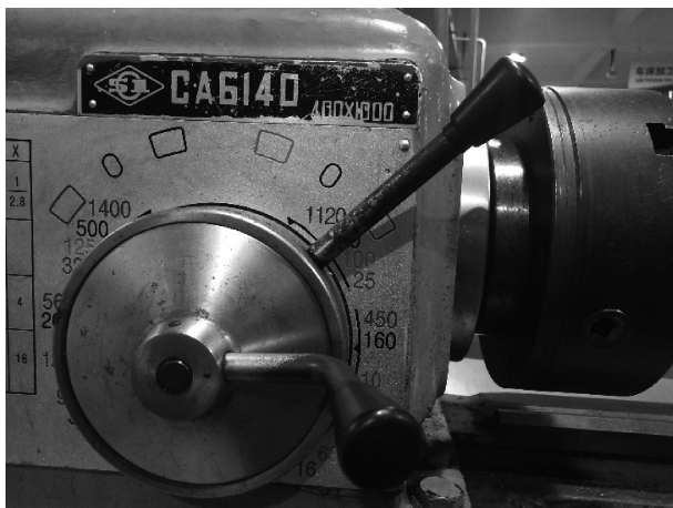
图 1-4 主轴转速为 10 r/min 时的手柄位置
