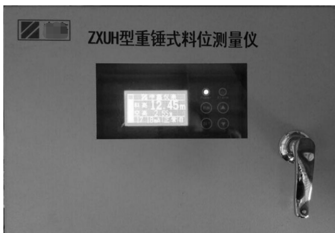
图 1-2 产品化的重锤料位计控制仪表
