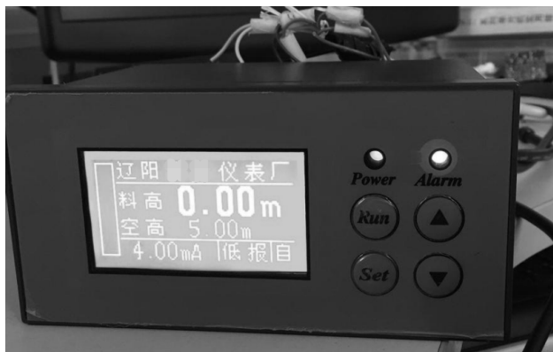
图 1-1 重锤料位计控制仪表
