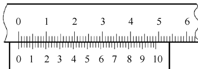
图 1-10 0.02 mm 游标卡尺的刻线原理
