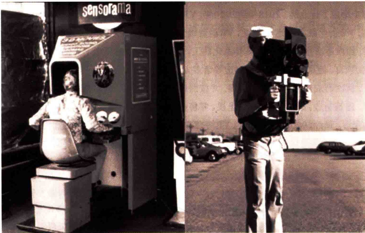
图1-2 仿真模拟器Sensorama实体图
