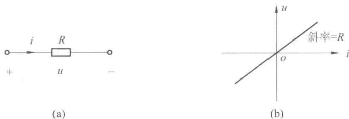
图 1-9 线性电阻的符号和伏安特性
