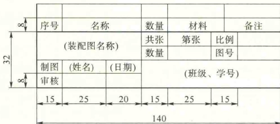
图 1-9 装配图标题栏格式
