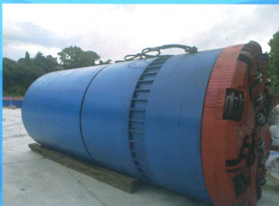
土建 3 标金水湖支线顶管机头 (DN2420)
