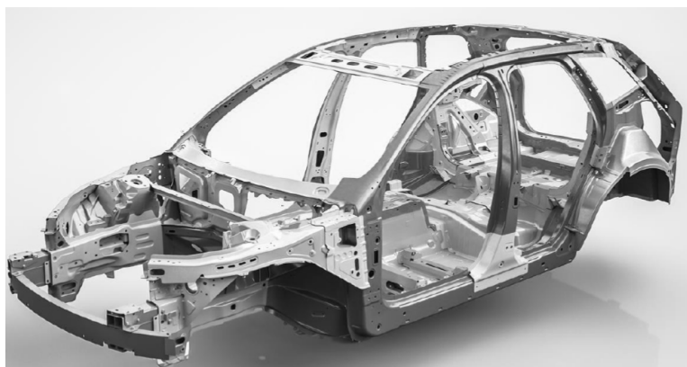
图 1-3 Volvo XC60 多材料车身
