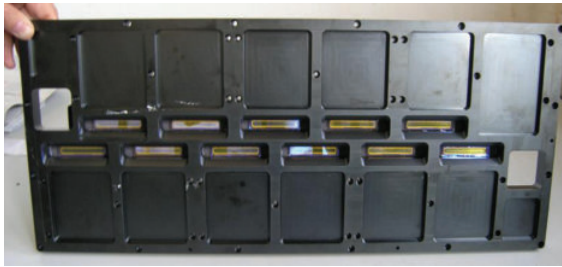
图 1-14 11 片 TDICCD 焦平面组件 FPA
