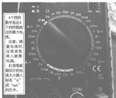
图 1-10 交直流电流的测量
