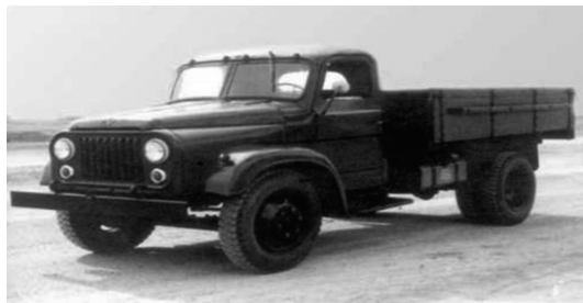
图 1-6 载重 5 t 的“东风”牌载货汽车
