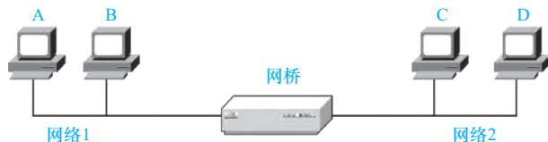
图 1.2 用网桥连接的网络
