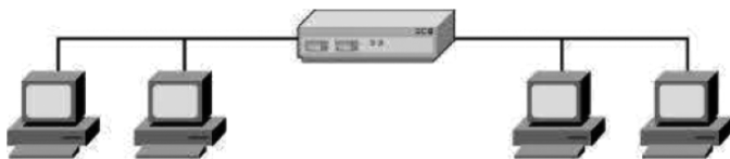
图 1.1 用中继器连接的网络
