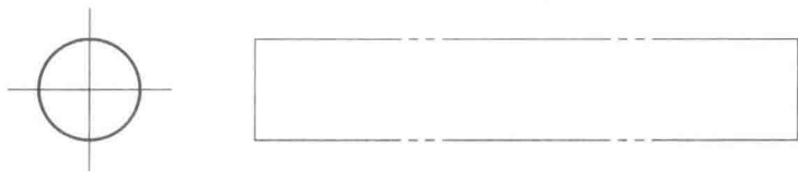
图 1-11 用细实线代替细点画线和双点画线
