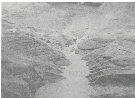
(a) 四渡河大桥地形模型风洞试验
