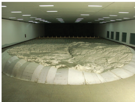
(d) 龙江大桥地形模型风洞试验
