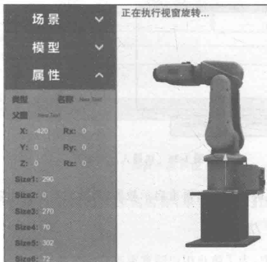
图 1-23 ABB 机器人的关节尺寸
