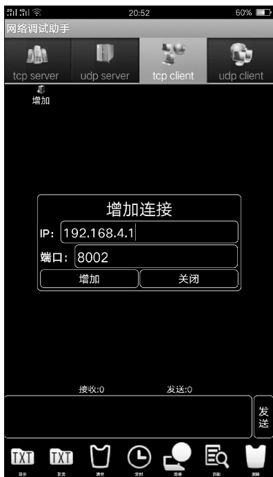
图 1-8 设置 tcpclient 连接参数
