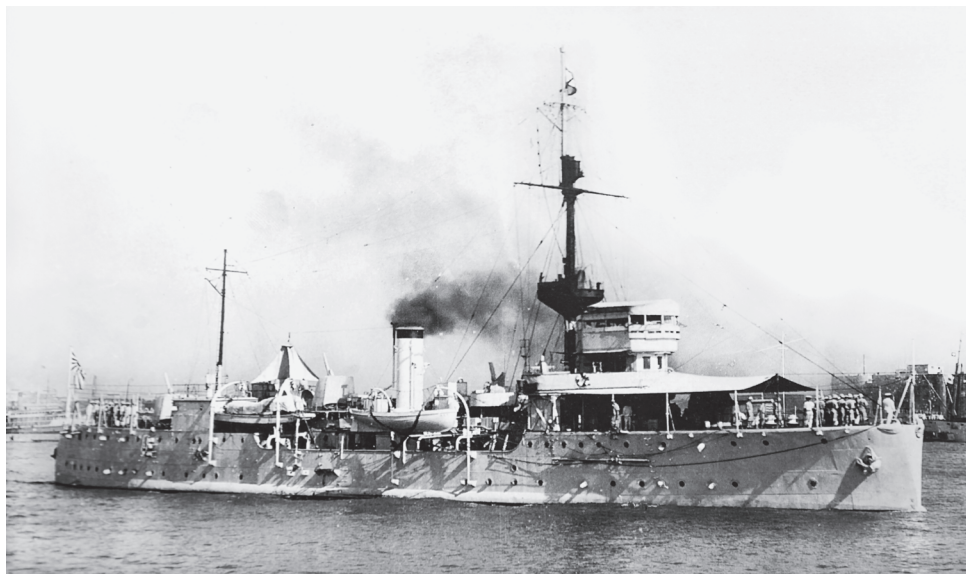
初次改装后的“安宅”舰，水线附近鼓出的“防雷隔堵”十分显眼。照片中可以看到巨大的前桅此时尚未拆除
