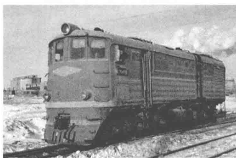
图 1-14 “巨龙号”电传动内燃机车
