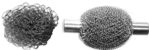
图 1-5 拉伸的螺旋卷及毛坯示意图
