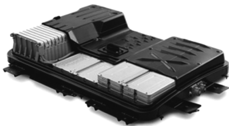
图 2-1 动力电池系统的外观
