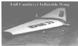
(b) 无人飞行器充气机翼
