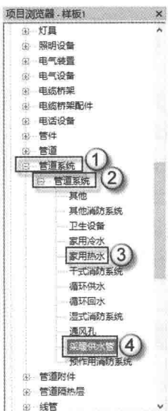
图 1.12 生成“采暖供水管”系统
