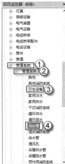
图 1.16 生成“污水管”系统
