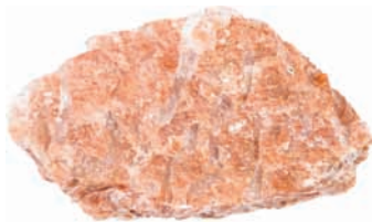
伟晶岩： 黄白色或灰白色，粗粒结构，主要矿物成分是长石和石英。
