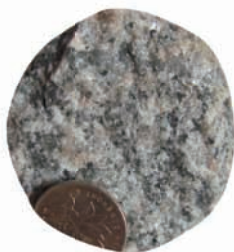
花岗岩： 灰白色或肉红色，中粗粒结构，主要矿物成分是石英和长石，是最常见的岩石类型之一。
