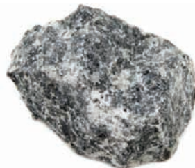
辉长岩： 灰黑色，中粗粒结构，辉长结构，主要矿物成分是长石和辉石。
