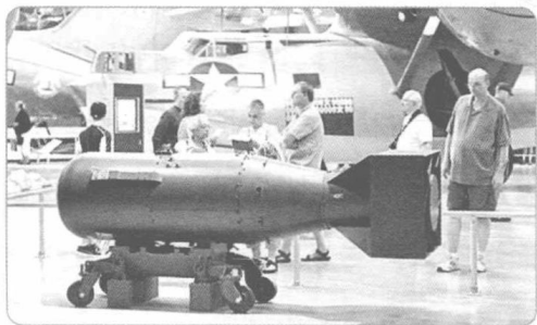
图1-1 游客们正在参观拆除核心部件的原子弹“小男孩”。该弹长10英尺（3米），宽28英寸（71厘米），重8900磅（4000公斤）。使用“枪式”设计，将一块低于临界质量的铀-235以炸药射向三个同样处于低临界的环形铀-235，造成整块超临界质量的铀，引发连锁反应。（图片来源：维基百科；作者：美国能源部）
