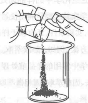
图 1-7 将试样转移到接收器的操作示意图
