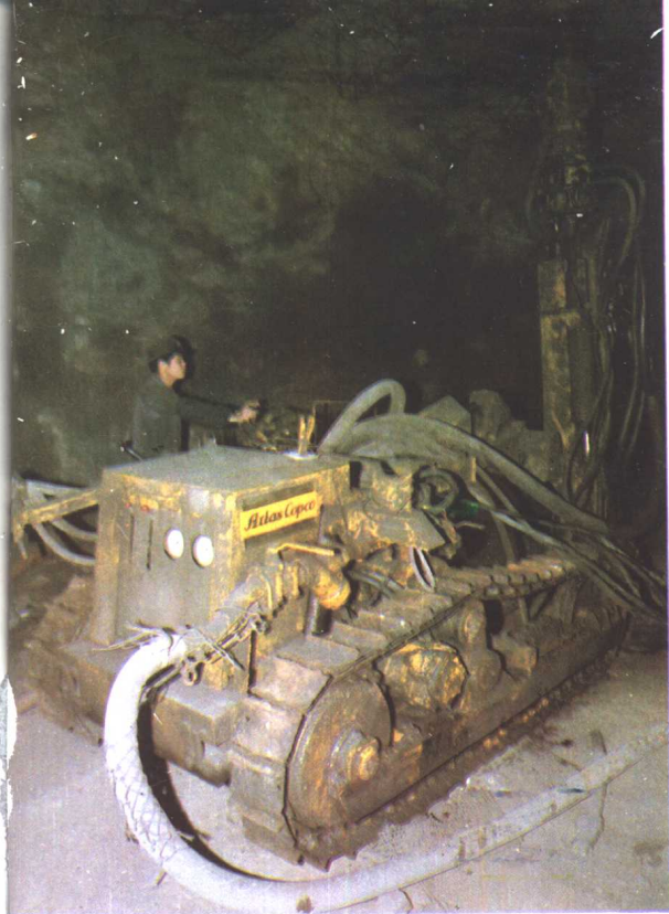
铜坑锡矿从国外引进的潜孔钻机在井下打钻。(王崇礼摄)
