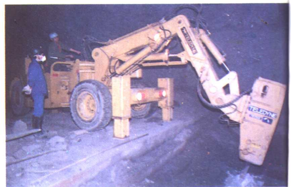
大厂矿务局铜坑锡矿从国外引进的碎石机在井下作业。(王崇礼摄)
