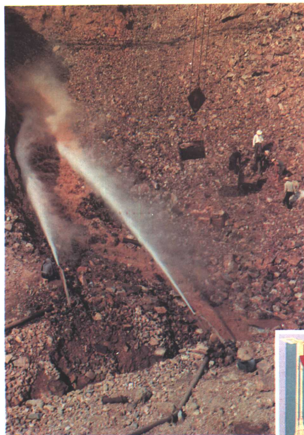
平桂矿务局新路矿水枪开采深埋砂矿。(平桂矿务局修志办供稿)
