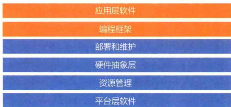
图 1-1 整体数据中心核心技术分层
