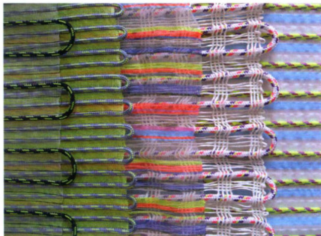
用锦纶单丝和尼龙绳织造的平纹组织实例
