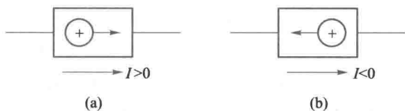
图 1.1.3 电流的实际方向与参考方向
